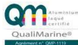
Le **label QUALIMARINE®** atteste qu'avant le thermolaquage les profilés aluminium ont fait l'objet d'un prétraitement chimique des plus exigeants pour accroître la résistance du produit final lorsqu'il est soumis à des conditions atmosphériques sévères.
